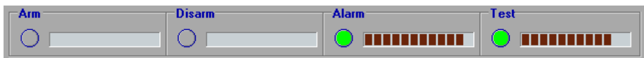
Рисунок 5. Отображение GSM терминалов на рабочем столе программы. Только терминал "Alarm" и "Test" подключен и функционирует корректно
