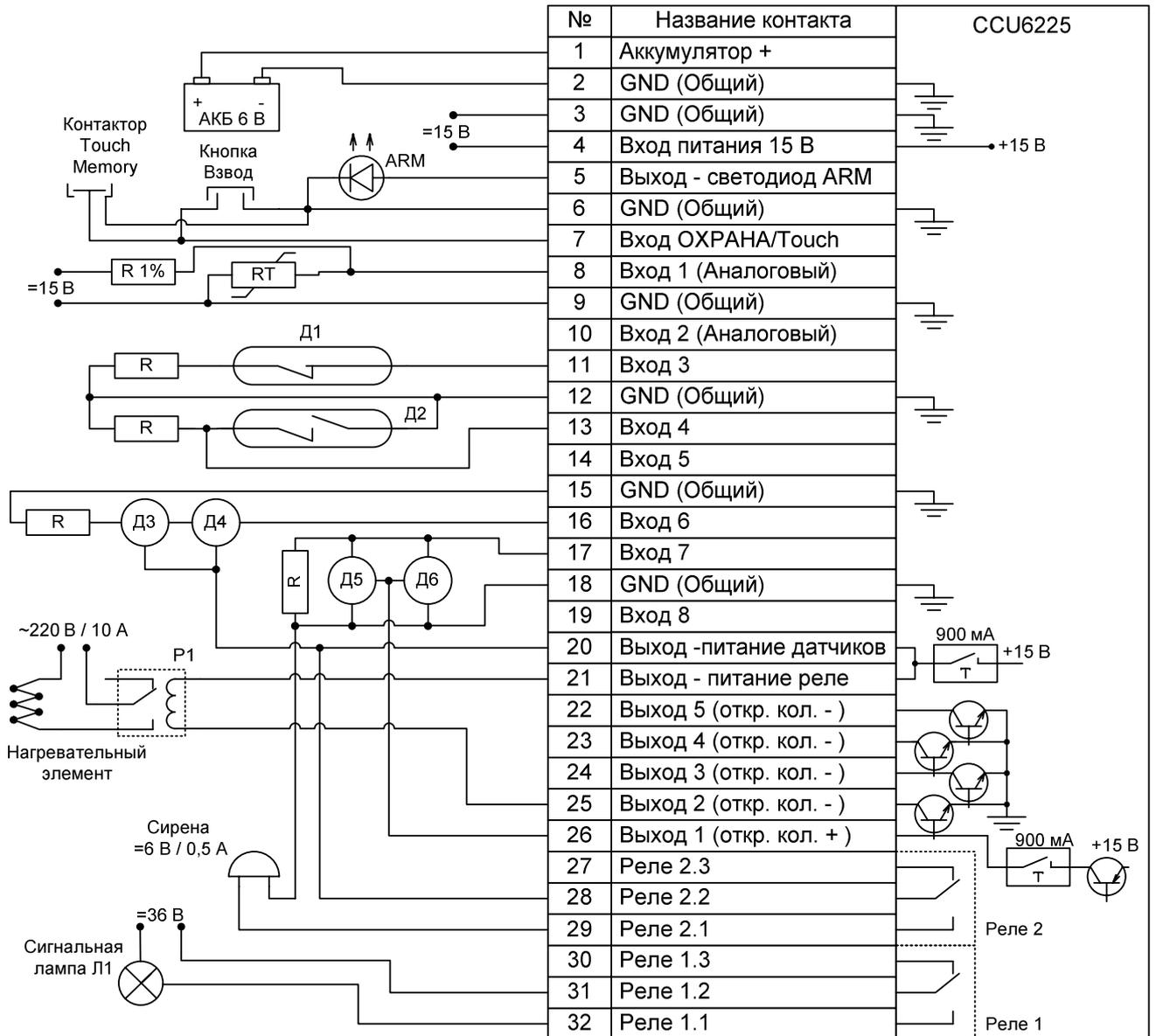
Рисунок 16. Схема подключения датчиков и других устройств
