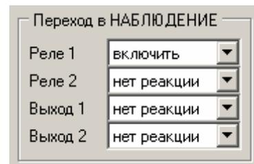
Реле 2 управляет сиреной. Нужно указать влияние на реле от всех входов, которые используются для подключения охранных датчиков. И включить параметр "Реле управляются тревожным событием" Тогда, при активизации любого входа, реле будет включено на указанное в конфигурации реле время или постоянно. Для удобства, это реле можно выключить при смене режима "ОХРАНА/НАБЛЮДЕНИЕ", т.е. с помощью ключа Touch memory или командой по SMS.
