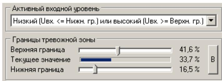
контролировать одно из тревожных событий на входе: замыкание или обрыв шлейфа, в зависимости от схемы включения. Рассмотрим несколько примеров. Максимальным уровнем 100% - считается напряжение на входе 5В.
