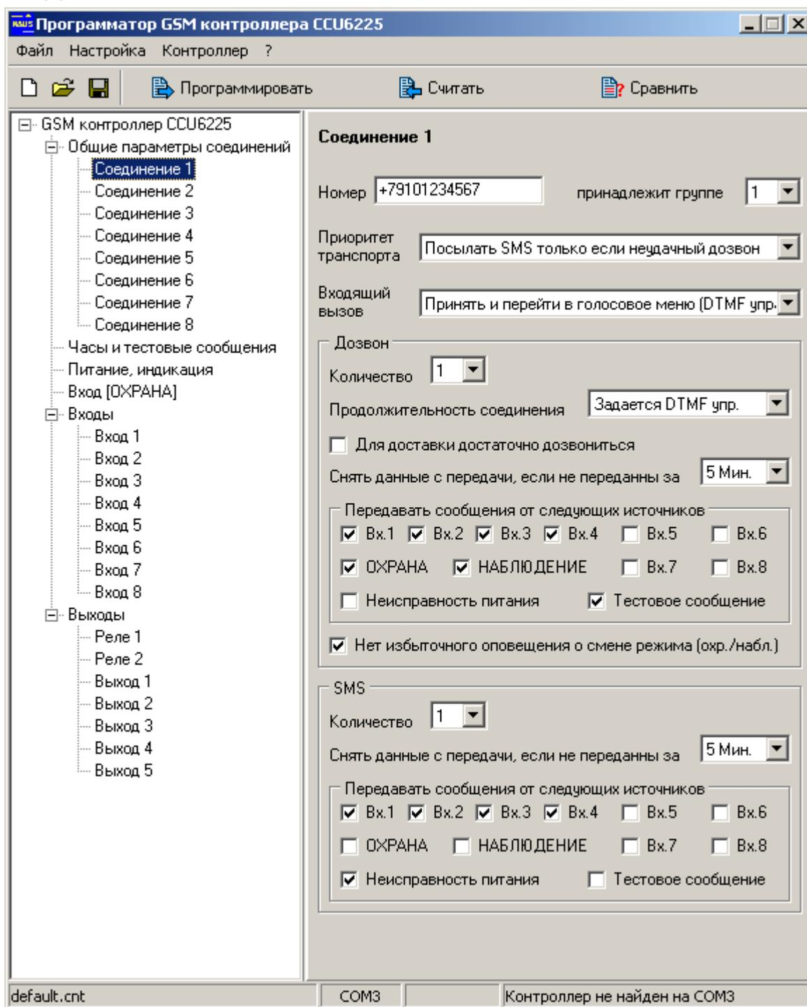
Рисунок 5.Параметры соединения
