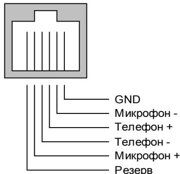
Рисунок 11. Назначение контактов телефонного разъема
