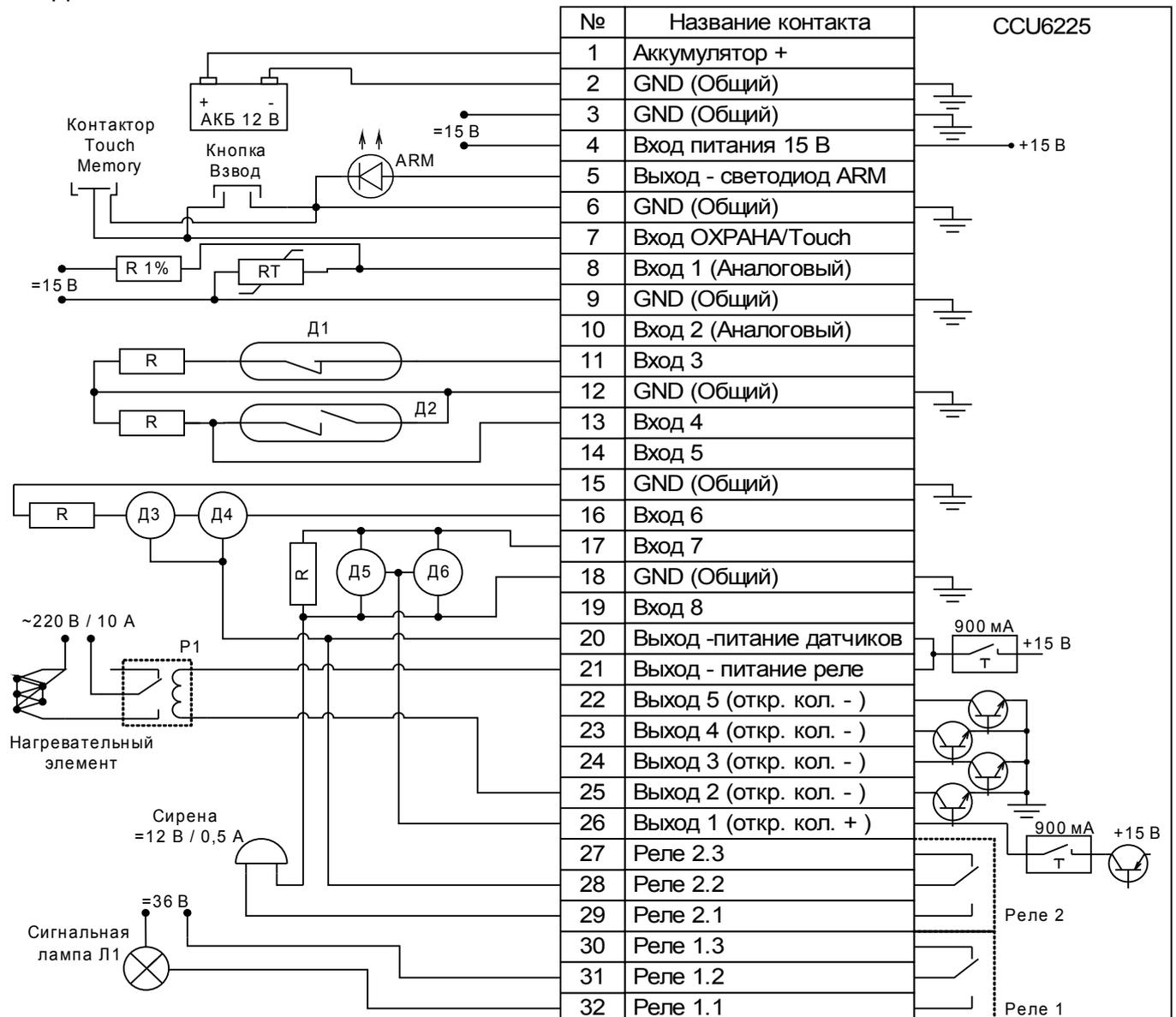
Рисунок 13. Схема подключения датчиков и других устройств
