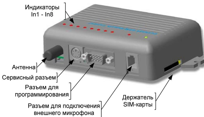
Рисунок 1. CCU6225 – основные элементы, сервисный разъем может отсутствовать
