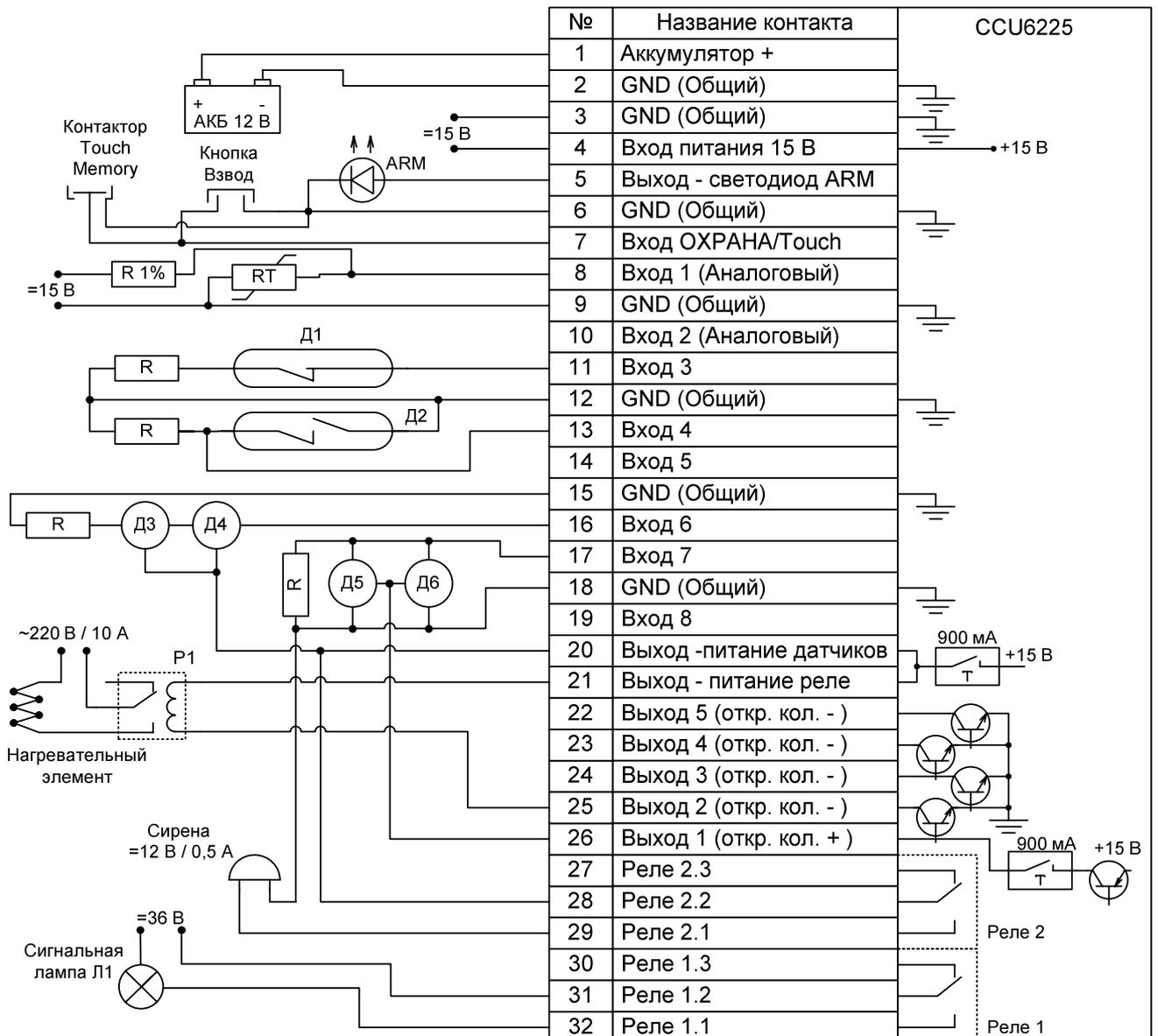
Рисунок 13. Схема подключения датчиков и других устройств
