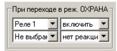
Реле 2 управляет сиреной. Нужно указать влияние на реле от всех входов, которые используются для подключения охранных датчиков. И включить параметр "**Реле управляются тревожным событием**". Тогда, при активизации любого входа, реле будет включено на указанное в конфигурации реле время или постоянно. Для удобства, это реле можно выключить при смене режима "ОХРАНА/НАБЛЮДЕНИЕ", т.е. с помощью ключа Touch memory или командой по SMS или DTMF.
