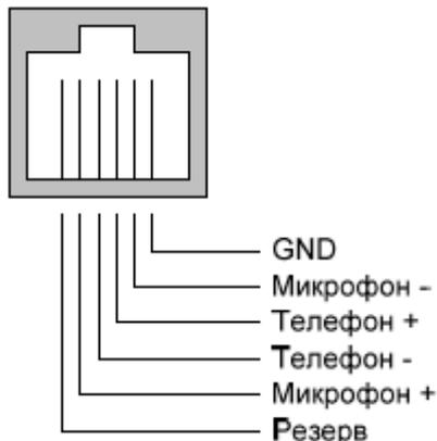
Рисунок 8. Назначение контактов телефонного разъема
