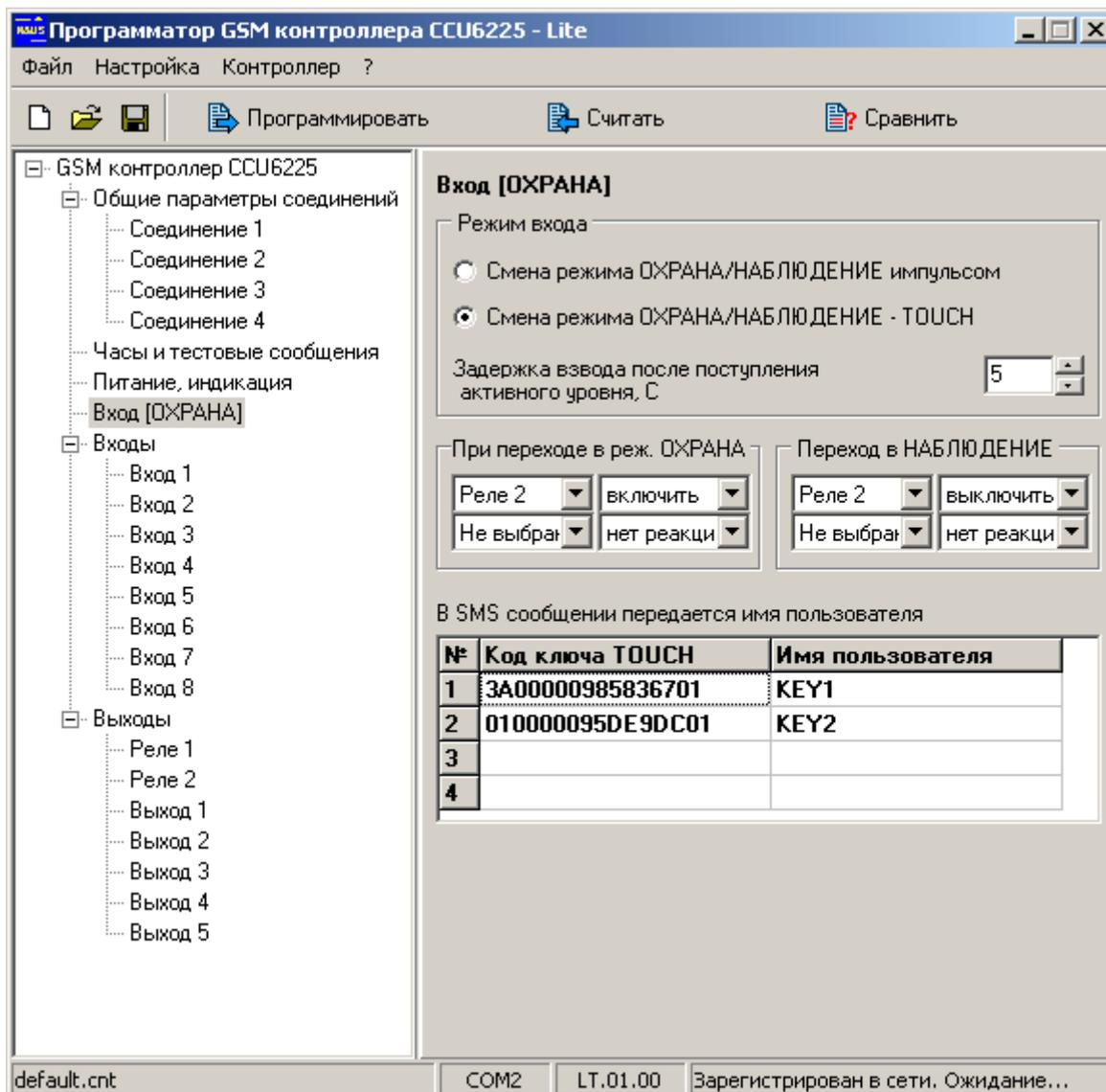
Рисунок 5. Настройка параметров входа "ОХРАНА"
