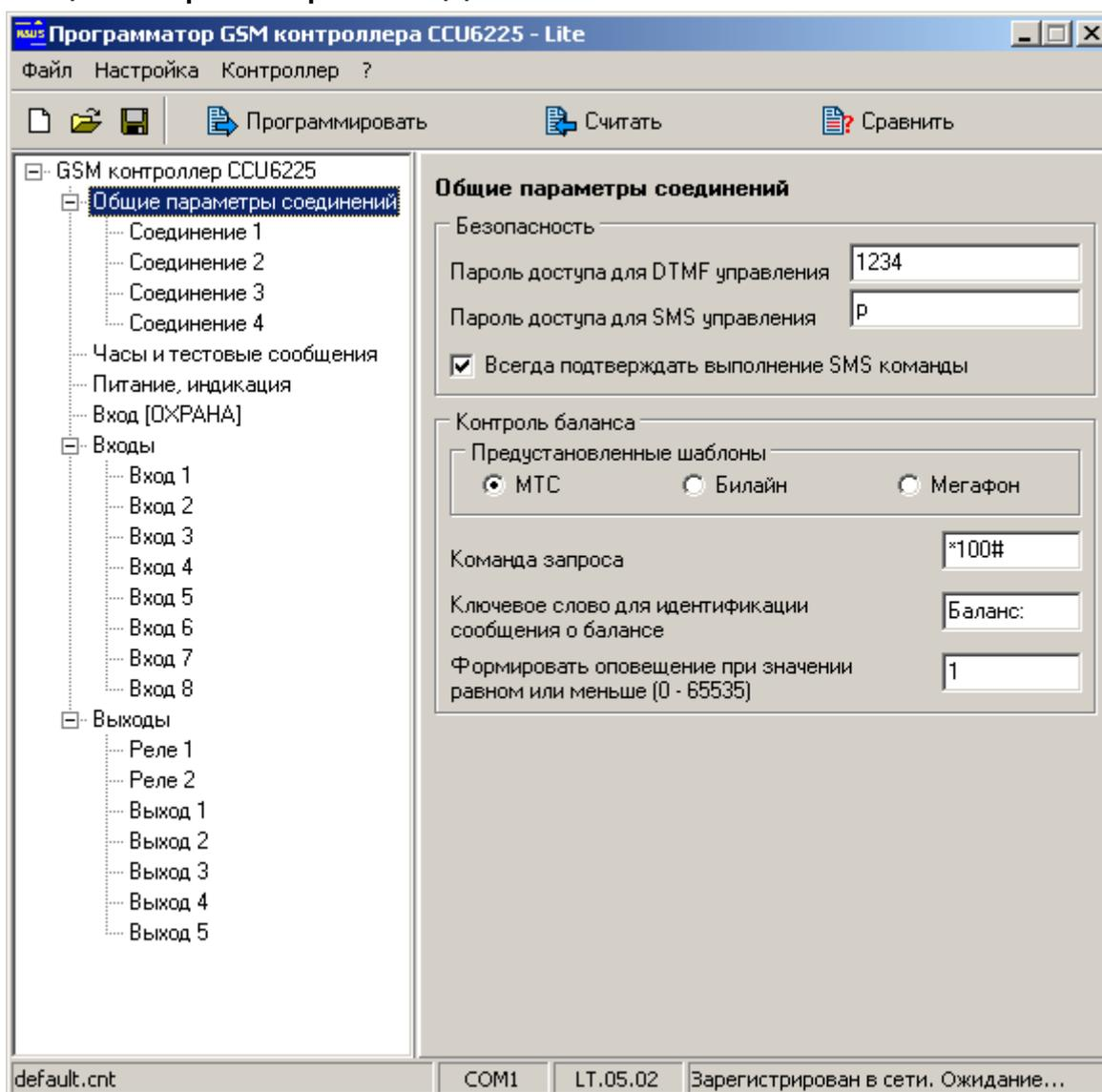
Рисунок 1. Общие параметры соединений
