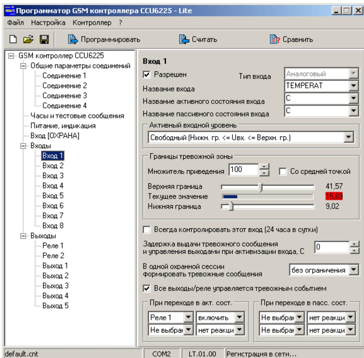
Рисунок 6. Типовая настройка параметров аналогового входа
