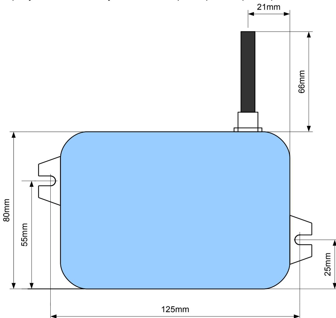
Рисунок 1: CCU6225-LT - установочные размеры
