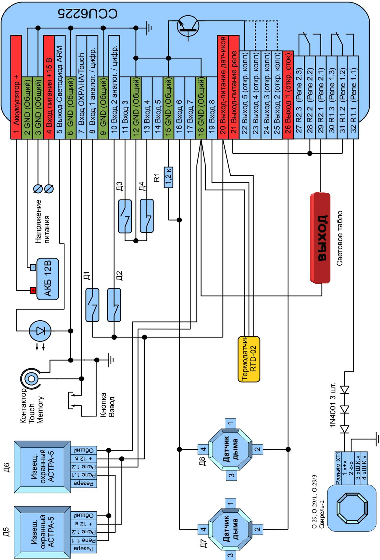
Рисунок 4: Схема подключения датчиков и других устройств
