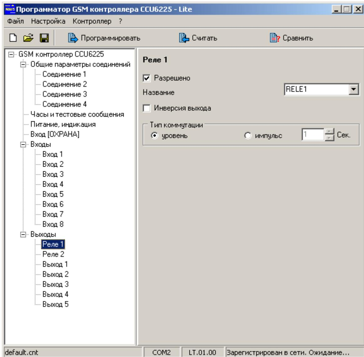
Рисунок 7. Типовая настройка параметров выходов
