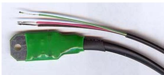
Рисунок 1. Термодатчик RTD-01
