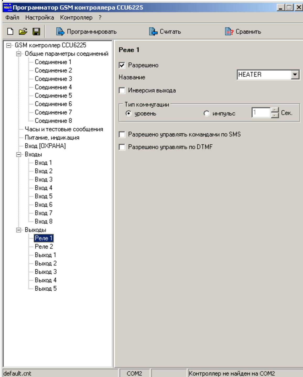
Рисунок 3. Настойка выхода для управления обогревателем
